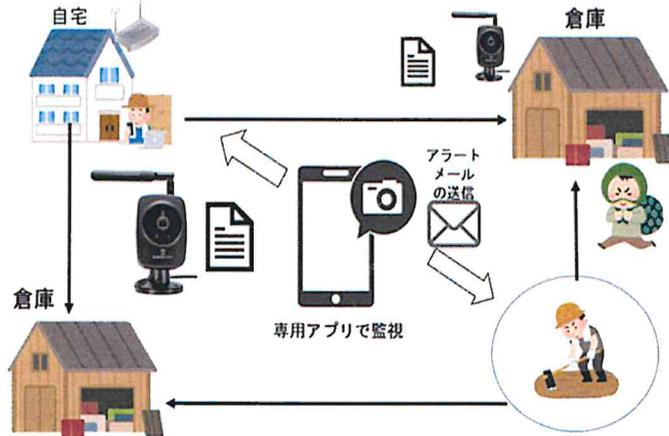
自宅や農作業中、倉庫や納屋への防犯対策や生育管理として、BWA-SIMを直接挿入できる監視カメラを設置。侵入者等を動体検知した場合、アラートメールなどが、お使いのスマートフォンに送信されます。特にBWAエリア内であり、通信キャリアのサービスエリア外に設置された倉庫や納屋の状況確認に有効です。
