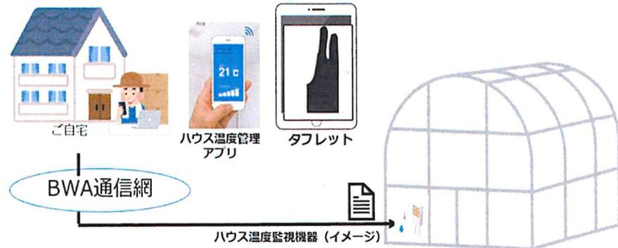
ビニールハウスにて、BWA-SIMを直接挿入できる温度管理等のセンサー機器を設置し、ハウスの状態を発信。高温等の温度状況の確認だけでなく、生育管理上にも有効です。特にBWAエリア内であり、通信キャリアのサービスエリア外に設置されたハウスで有効です。
